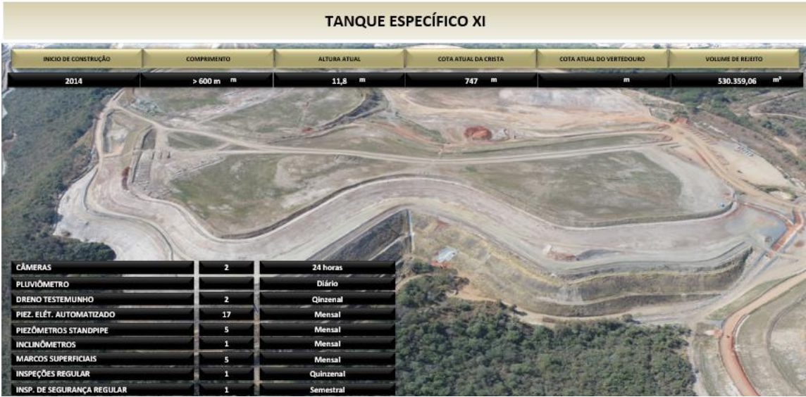
Figura 8 - Monitoramento e Instrumentação Tanque Específico XI.
