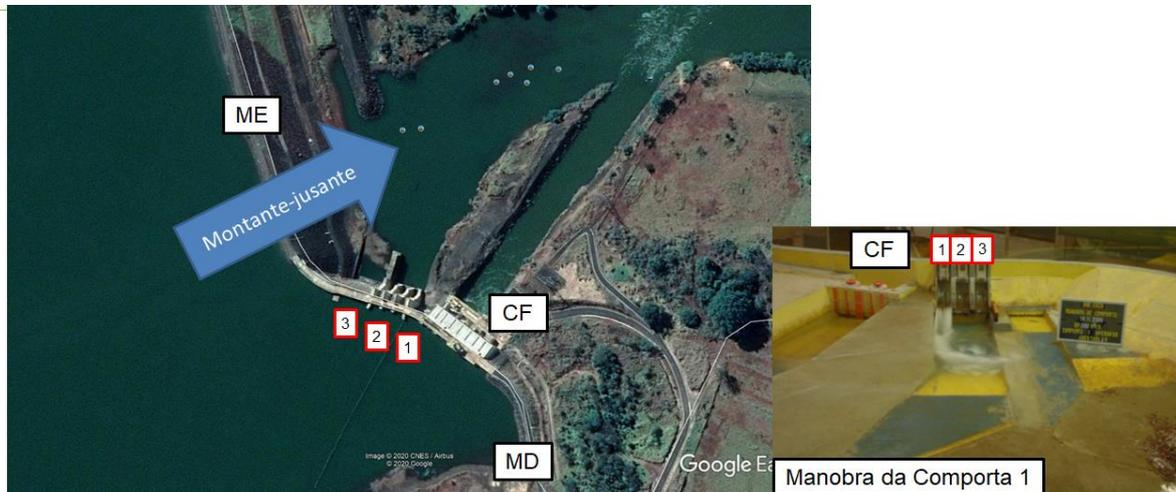
**Figura 1. Ilustração do posicionamento das comportas para a UHE Caçu.**
