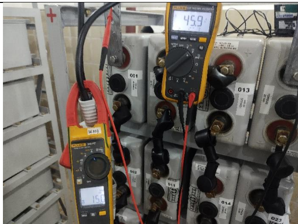
Figura 39 – – Medições de tensão e corrente do ciclo 9hs...
