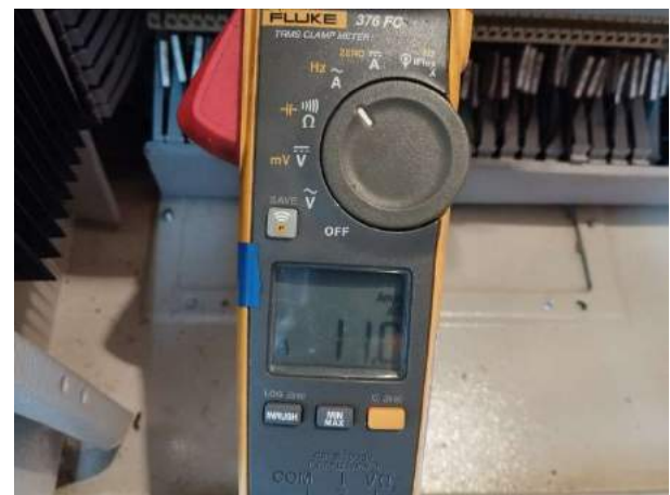
Figura 126 – Verificação das correntes dos motores (com carga) VT - 3
