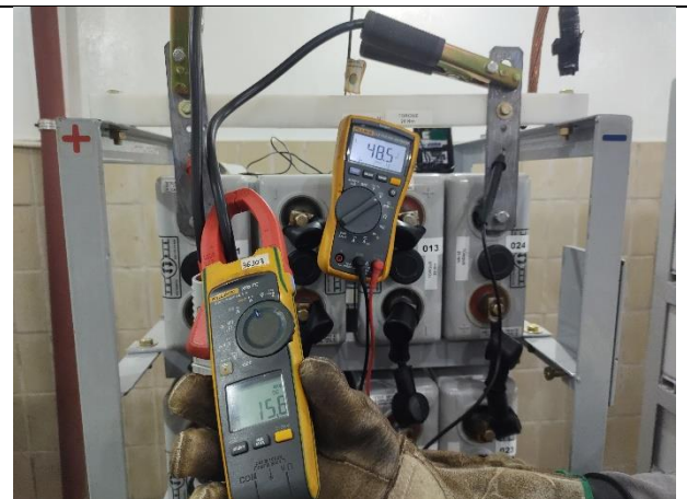
Figura 16 – Medições de tensão do ciclo 1hs.
