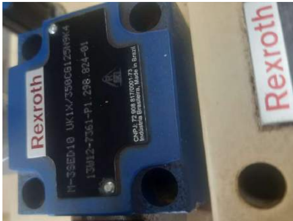
Figura 89 – Verificações nos assentos das válvulas direcionais
