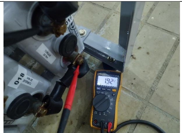
Figura 40 – Medição de tensão VPE do ciclo 9hs..
