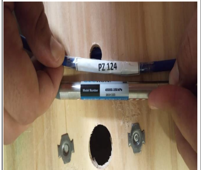
Foto 08 – Piezômetro elétrico PE-124, número de série 2031333 e modelo 4500C-350 KPa.
