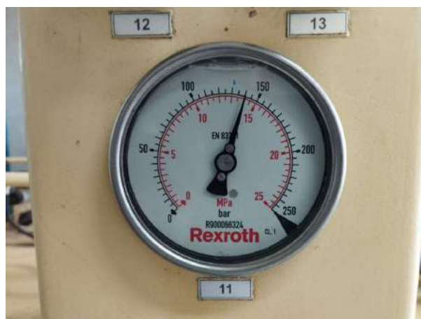
Figura 76 – Pressão de trabalho VT – 2 durante testes (140 bar)
