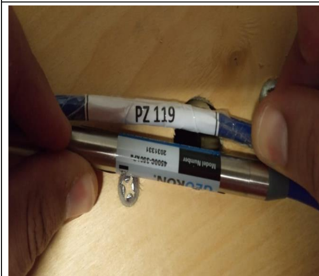
Foto 03 – Piezômetro elétrico PE-119, número de série 2031331 e modelo 4500C-350 KPa.
