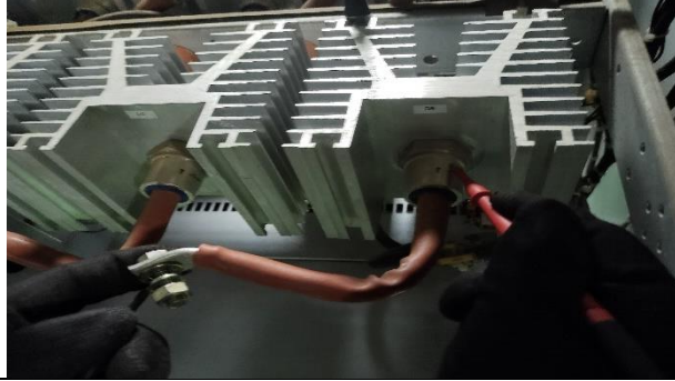
Figura 17: Feita medições dos diodos presentes no retificador.
