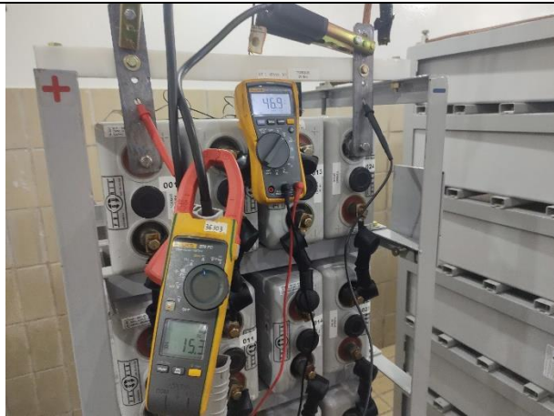
Figura 33 – Medições de tensão e corrente do ciclo 7hs.
