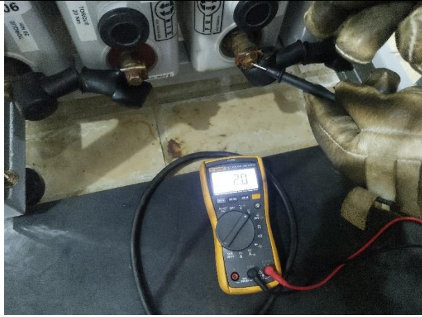
Figura 25 – Medição de tensão VPE do ciclo 4hs.
