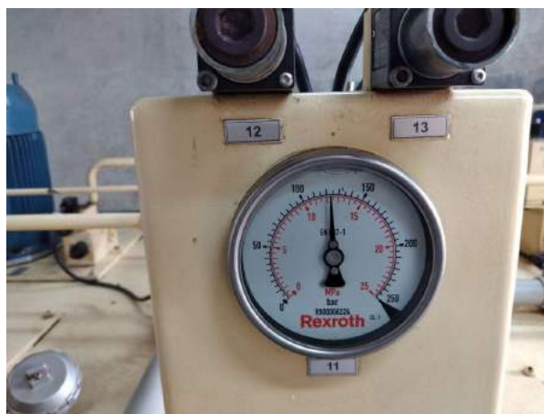
Figura 48 – Pressão de trabalho VT – 1 ensecada (125 bar)
