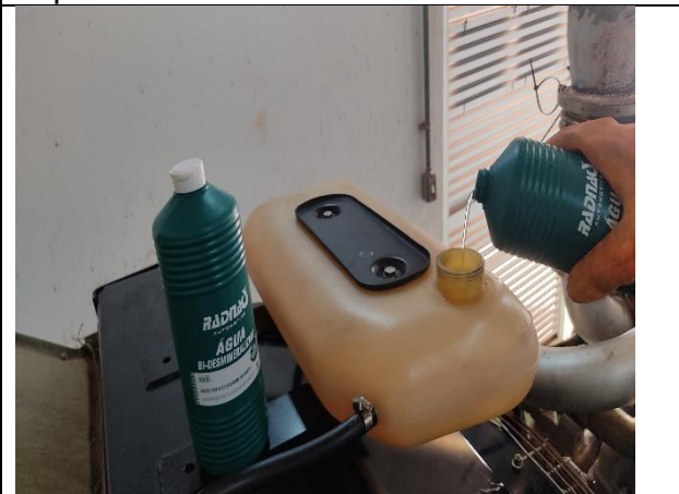
Figura 12- Água Desmineralizada no Sistema de Arrefecimento.
