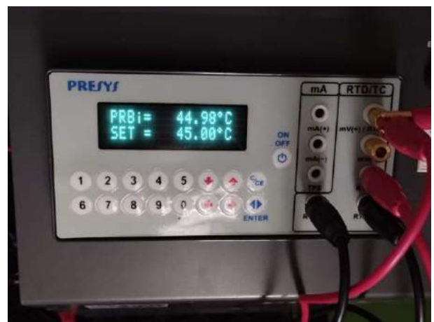
Figura 31 – Testes de variação de temperatura no equipamento
