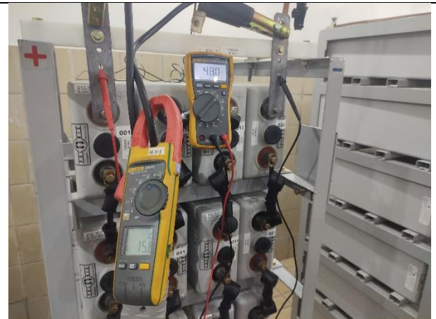
Figura 22 – Medição de tensão VPE do ciclo 3hs.
