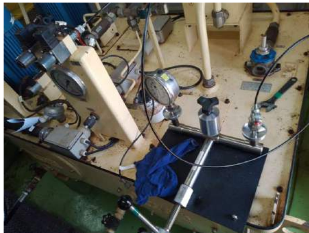
Figura 95 – Teste de atuação de baixa pressão UHVT-03
