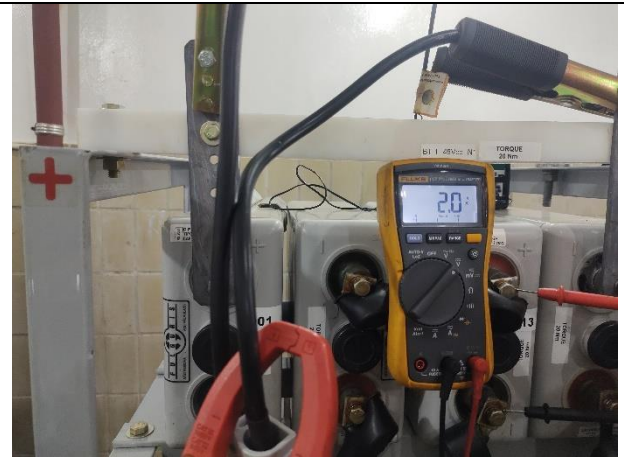
Figura 28 – Medição de tensão VPE do ciclo 5hs.
