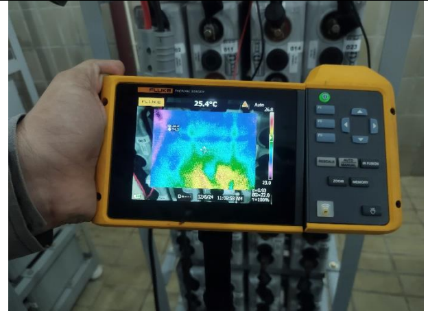
Figura 26 – Medição de temperatura dos elementos do ciclo 4hs.
