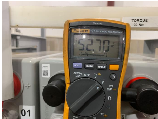
Figura 07 – Medições de tensão do conjunto do banco de baterias repouso.
