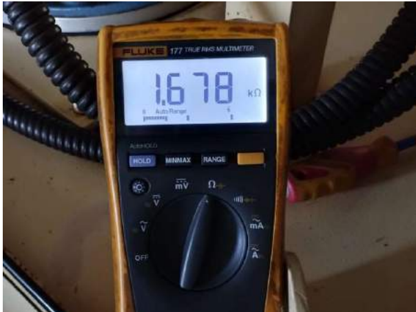
Figura 23 – Verificações na resistência de aquecimento do motor 1
