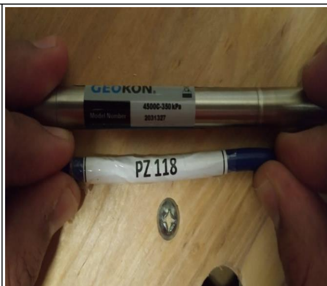
Foto 02 – Piezômetro elétrico PE-118, número de série 2031327 e modelo 4500C-350 KPa.
