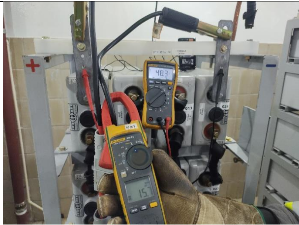
Figura 21- Medições de tensão e corrente do ciclo 3hs..
