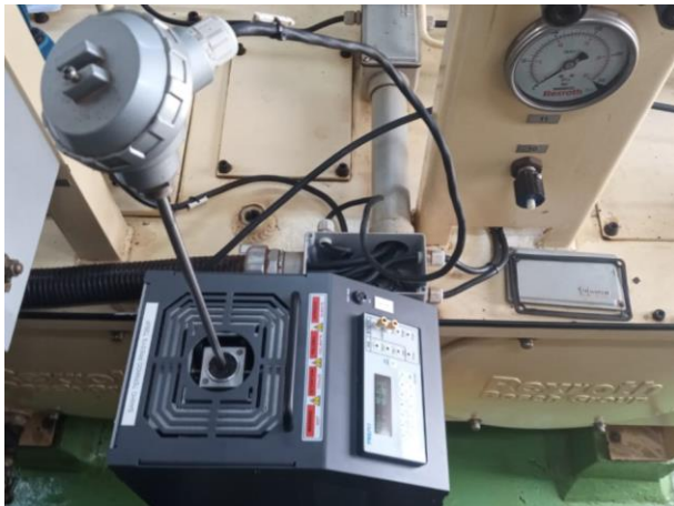
Simulação de temperatura através do Banho Térmico
