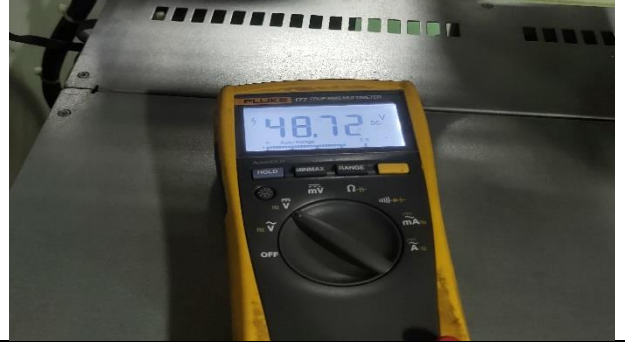
Figura 18: Feita medições dos diodos presentes no retificador.
