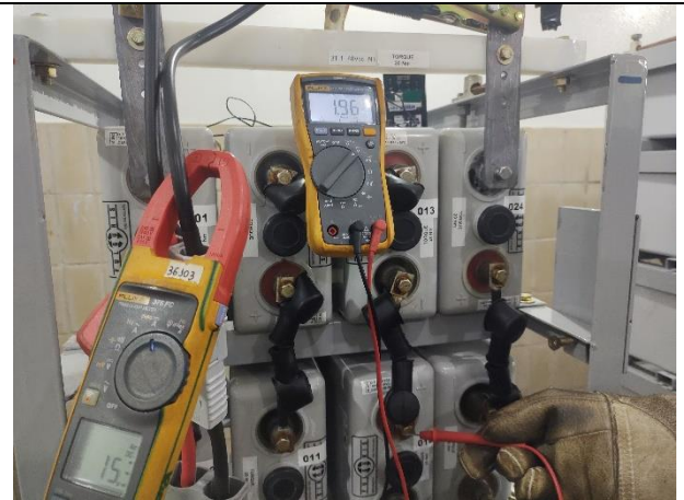
Figura 34 - Medição de tensão VPE do ciclo 7hs.
