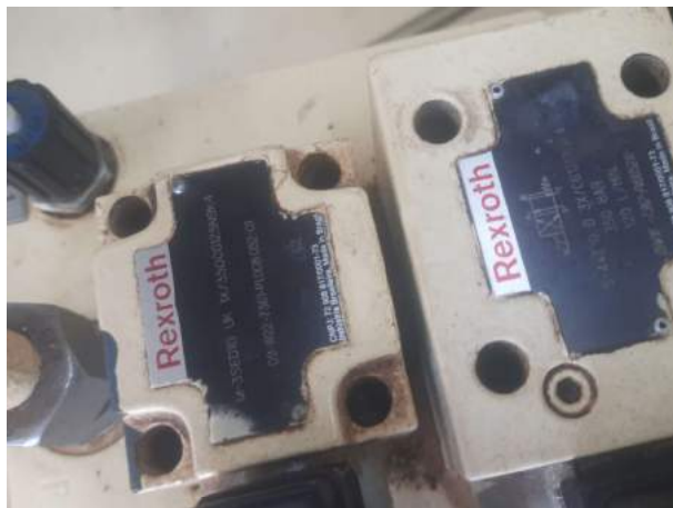
Figura 11 – Verificações nos assentos das válvulas direcionais
