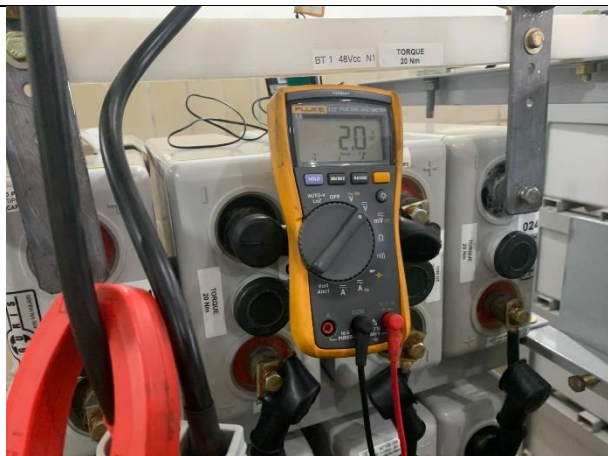
Figura 15 – Medição de temperatura dos elementos do ciclo 1hs.
