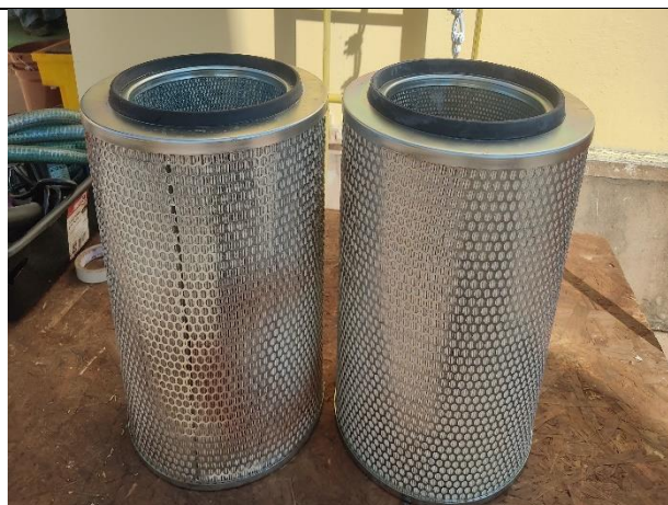
Figura 04 - Comparativo dos dois Filtros de Ar, Esquerda Usado e Direita o Novo.
