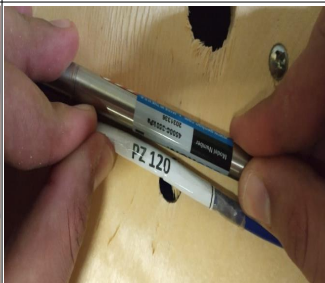
Foto 04 – Piezômetro elétrico PE-120, número de série 2031336 e modelo 4500C-350 KPa.
