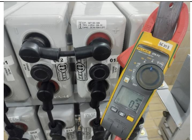
Figura 52 – Corrente do iniciou aplicação de carga nas baterias.
