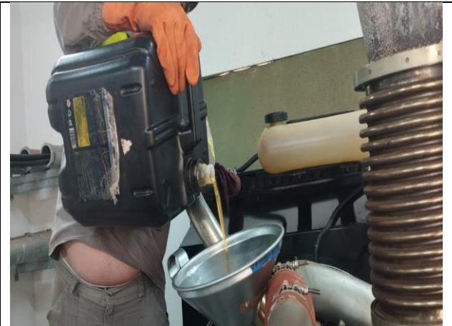
Figura 16 - Substituição do óleo diesel novo.
