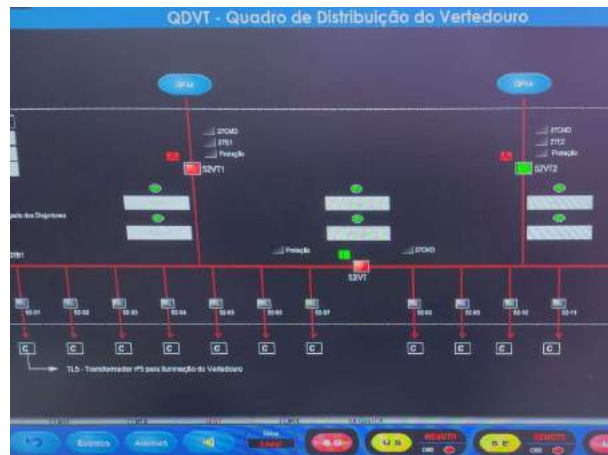
Figura 47 – Quadro de distribuição do vertedouro
