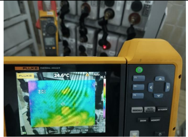
Figura 44 - Medição de temperatura dos elementos do ciclo 10hs
