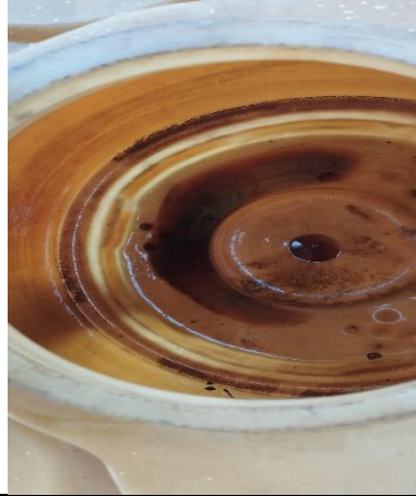
Figura 22 – Borra do óleo diesel
