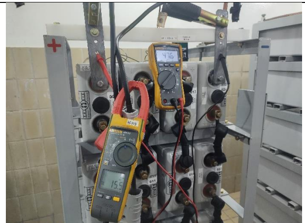
Figura 28 – Medição de tensão VPE do ciclo 5hs.
