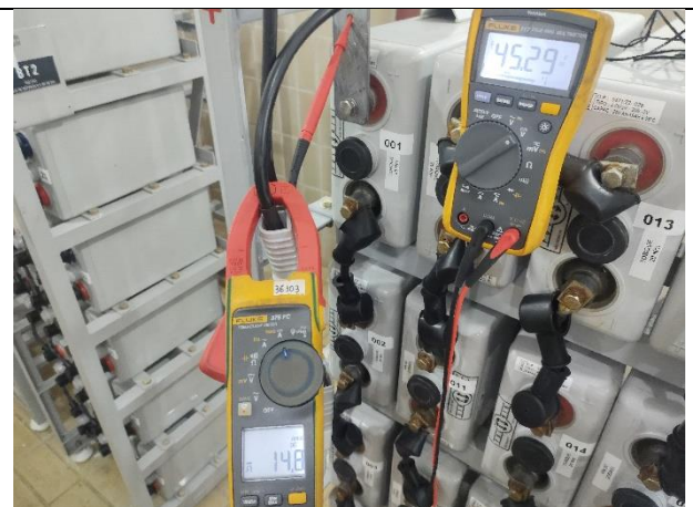
Figura 40 – Medição de tensão VPE do ciclo 9hs..
