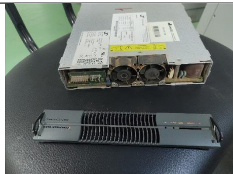
Figura 16: Feita limpeza da fonte do retificador 48Vcc.
