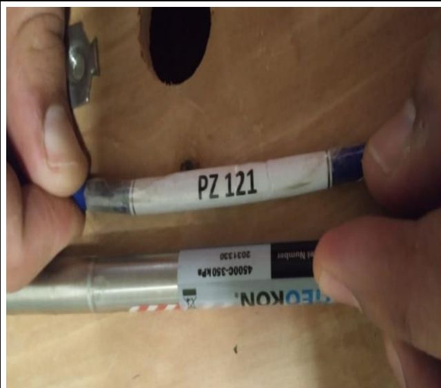
Foto 05 – Piezômetro elétrico PE-121, número de série 2031330 e modelo 4500C-350 KPa.
