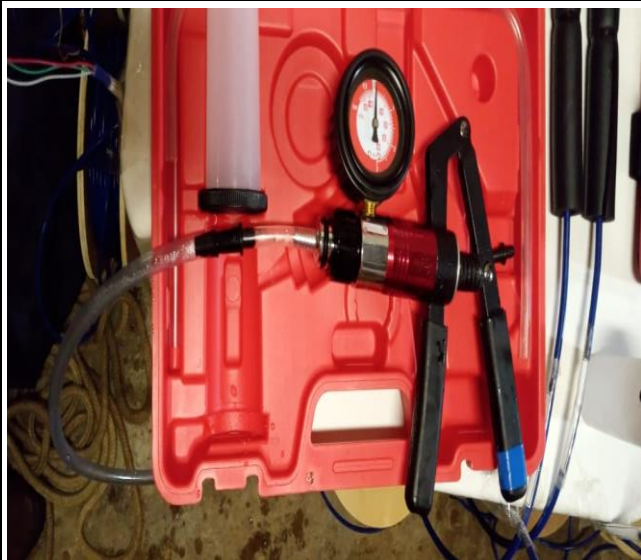
Foto 11 – Bomba a vácuo para injeção d'água por pressão.
