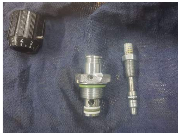
Figura 12 – Inspeção nas válvulas reguladoras de fluxo UHVT-01-02
