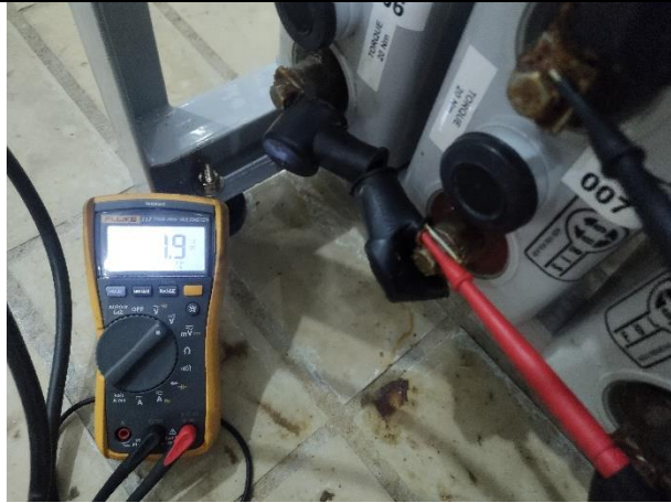
Figura 43 - Medição de tensão VPE do ciclo 10hs.
