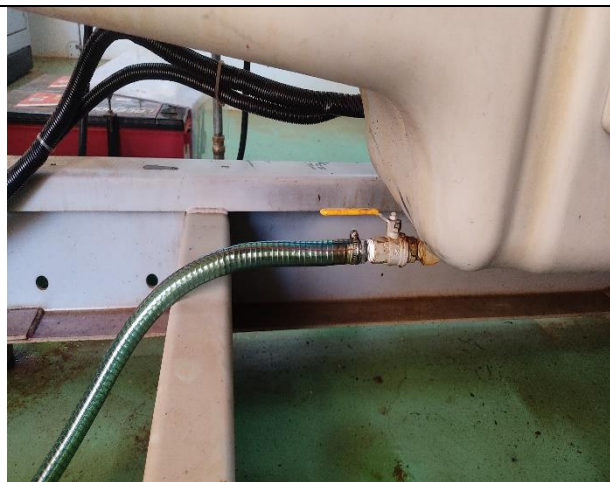
Figura 02 – Drenagem óleo do Cárter.
