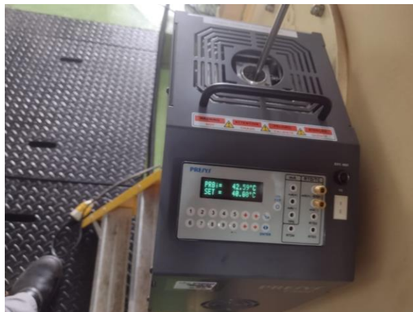
Testes de variação de temperatura no equipamento com a cuba térmica. UHVT-01-02
