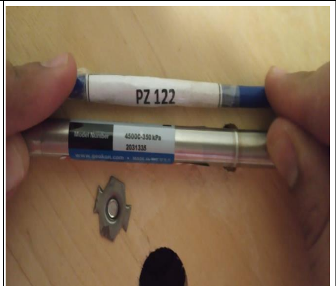
Foto 06 – Piezômetro elétrico PE-122, número de série 2031335 e modelo 4500C-350 KPa.
