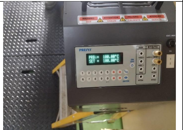
Testes de variação de temperatura no equipamento com a cuba térmica. UHVT-01-02
