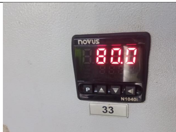
Temperatura simulada através do banho térmico
