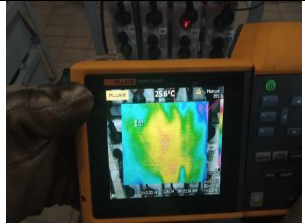
Figura 20 – Medição de temperatura dos elementos do ciclo 2hs
