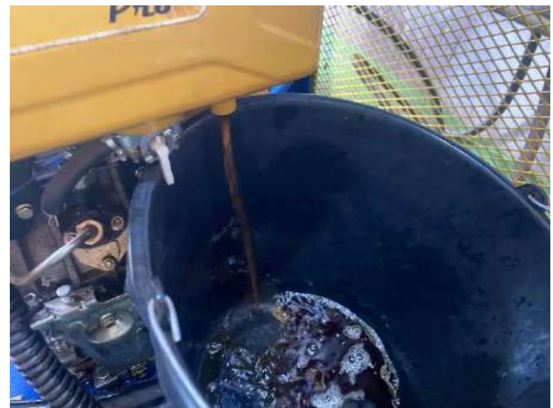
Figura 59 – Substituição do combustível do motor a diesel UHVT-01-02
