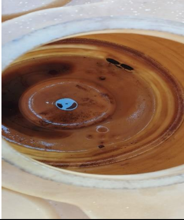
Figura 21 – Borra do óleo diesel
