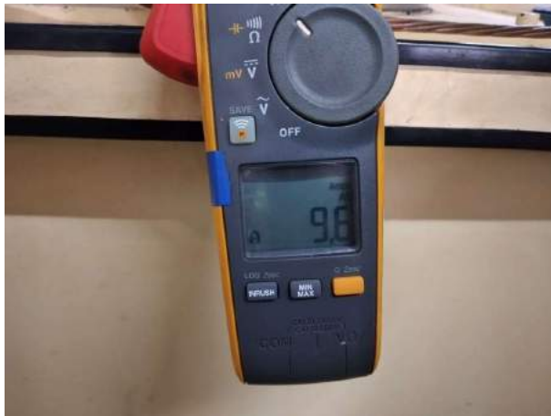
Figura 54 – Medição de corrente do motor B1OL1 com carga
