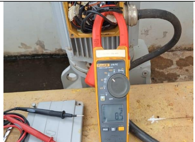
Figura 03 – Corrente do motor de 8,5A durante o travamento do Pórtico
