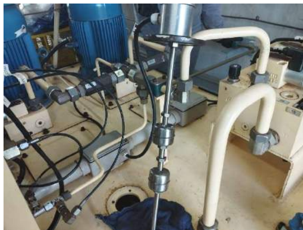
Figura 25 – Testes na chave de nível UHVT-01-02
