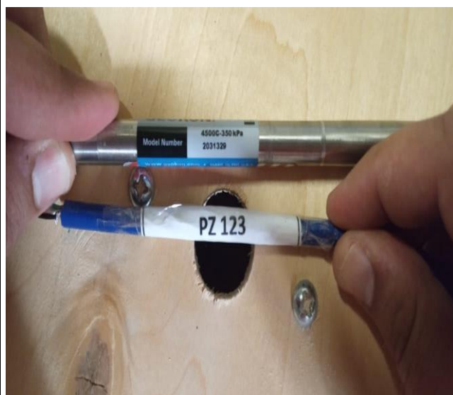
Foto 07 – Piezômetro elétrico PE-123, número de série 2031329 e modelo 4500C-350 KPa.
