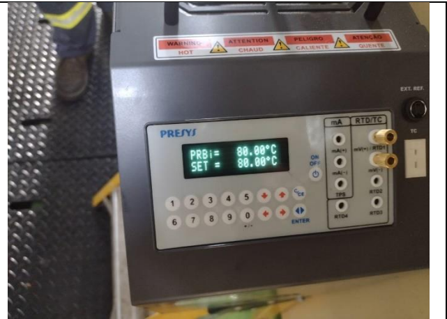
Testes de variação de temperatura no equipamento com a cuba térmica. UHVT-01-02
