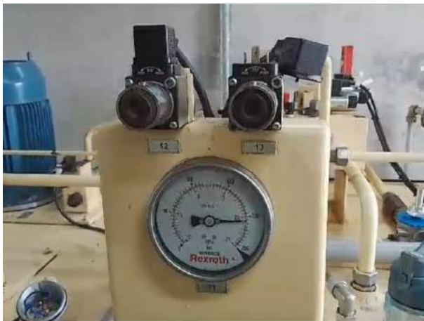
Figura 15 – Teste na válvula de alívio UHVT-01-02 (210 bar)
