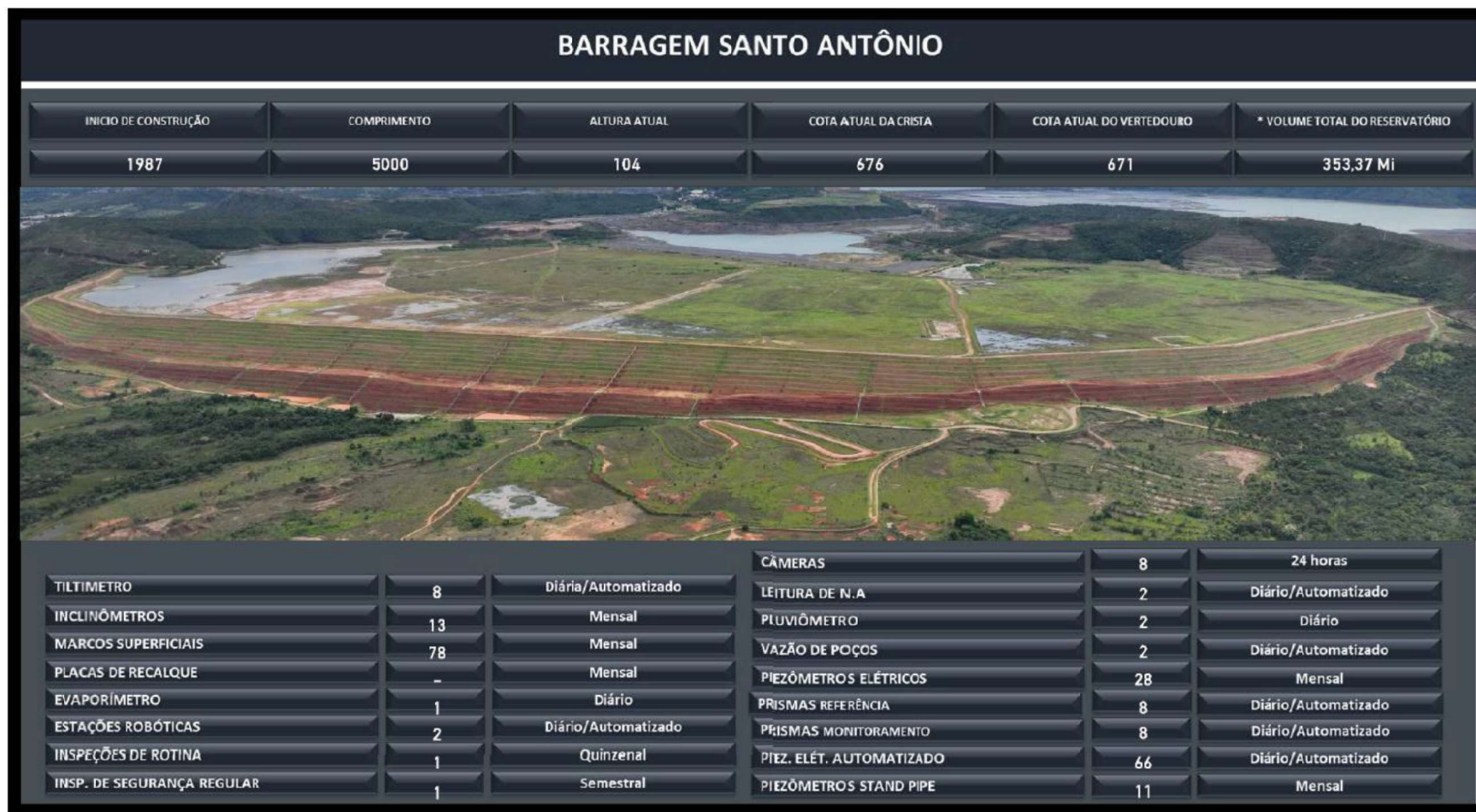
Figura 11 - Monitoramento e Instrumentação Barragem Santo Antônio.
